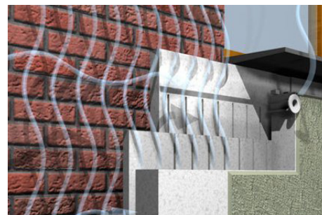
Osazení IZOBETA panelu
