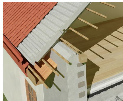
Schématické napojení střešní desky Izodom na zeď.
